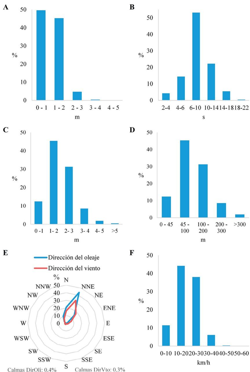
A) Altura de Hs; B) Tp; C) Altura de Hmax; D) L; E) Dirección de oleaje y viento; F) Velocidad del viento
